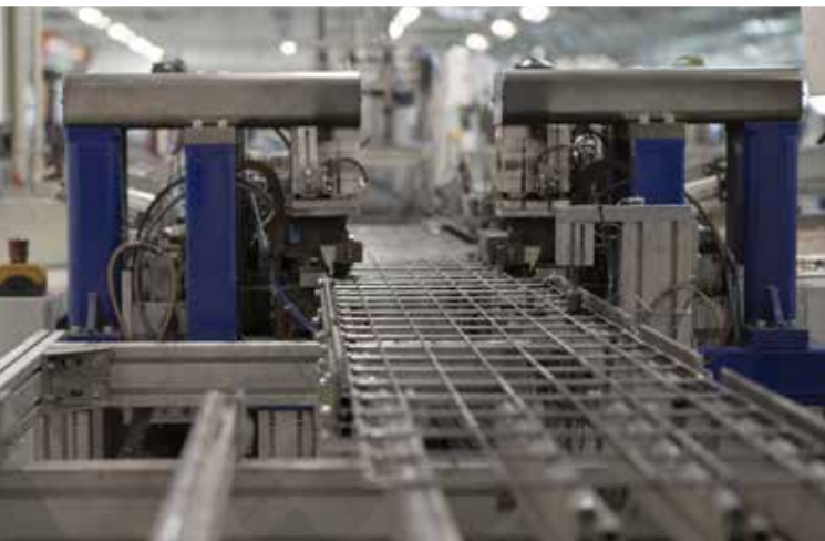
◀ ▶ Mittelfrequenz-Schweißzentren für das Schweißen der Drahtkonstruktion der Rinnen MERKUR 2.
