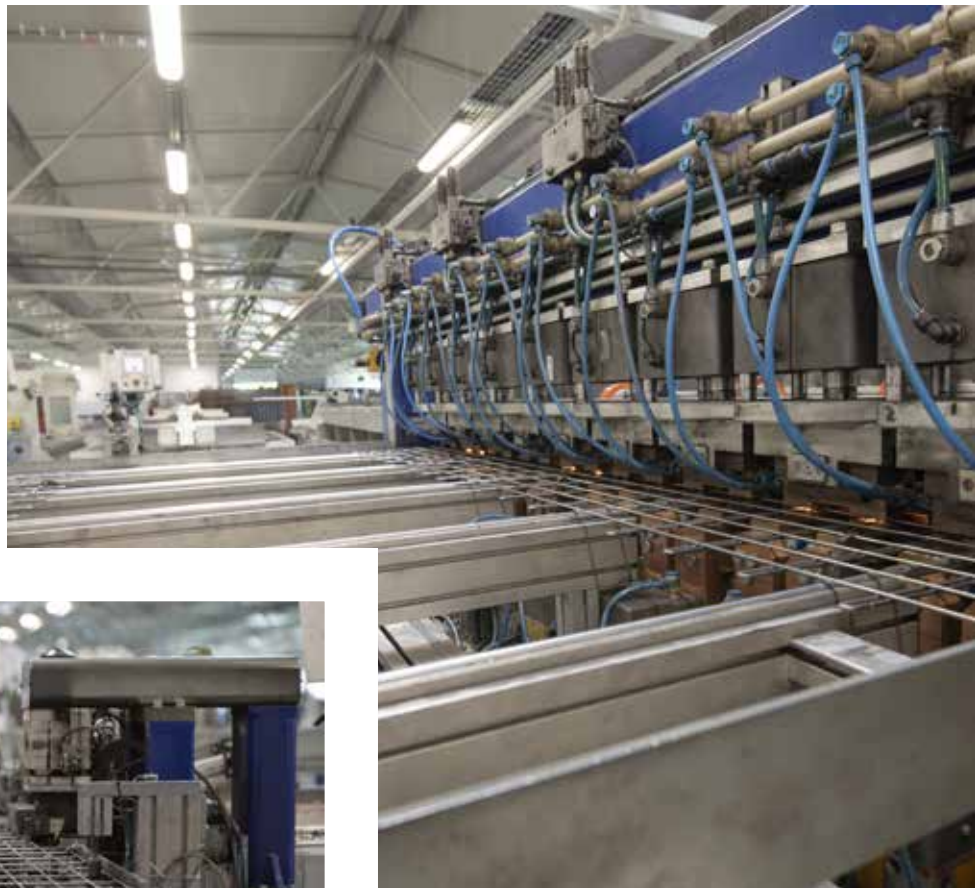
◀ ▶ Mittelfrequenz-Schweißzentren für das Schweißen der Drahtkonstruktion der Rinnen MERKUR 2.
