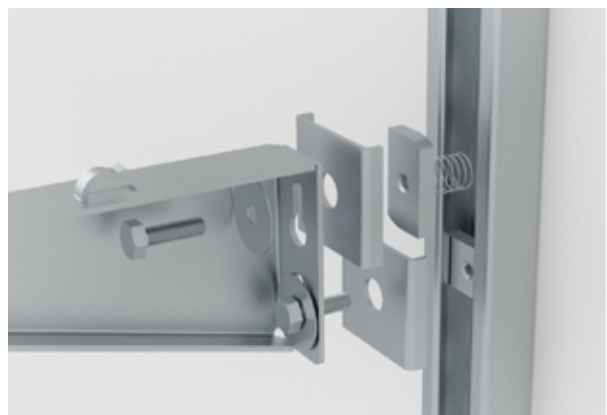
Die Rechteckmutter MSM/M6 wird zur Verankerung der Träger NZM und NZMU der Größe 50-200 an der Vertikalstütze verwendet.
